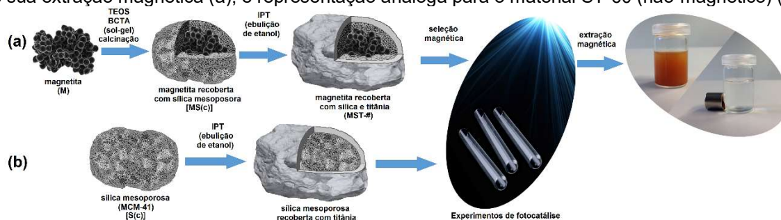
Figura 3.1 – Representação esquemática da síntese dos materiais MST-# , experimento fotocatalítico e sua extração magnética (a), e representação análoga para o material ST-60 (não-magnético) (b).
