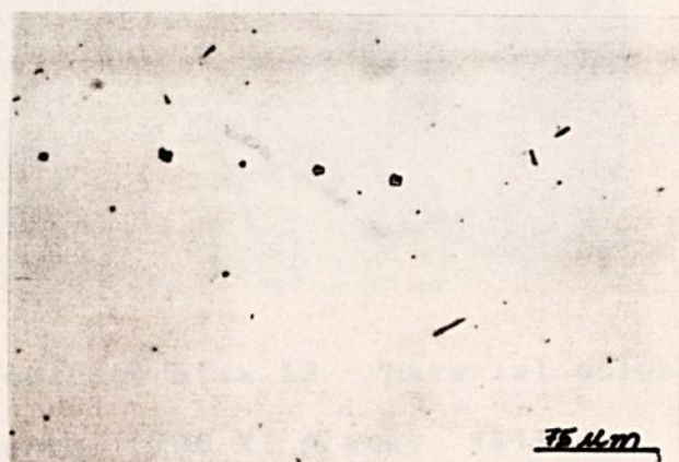
Figura 47 - Fotomicrografia n° 11 - Material solubilizado Aumento: 200 X. Sem Ataque.
