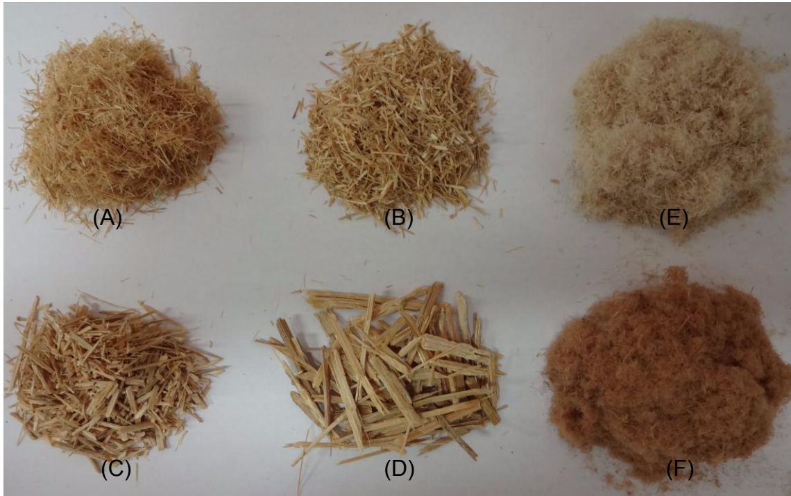
Figura 8. Diferença entre partículas e fibra, 60 mesh (A), 35 mesh (B), 20 mesh (C), 9 mesh (D), fibra de cana-de-açúcar (E) e fibra de eucalipto (F)
