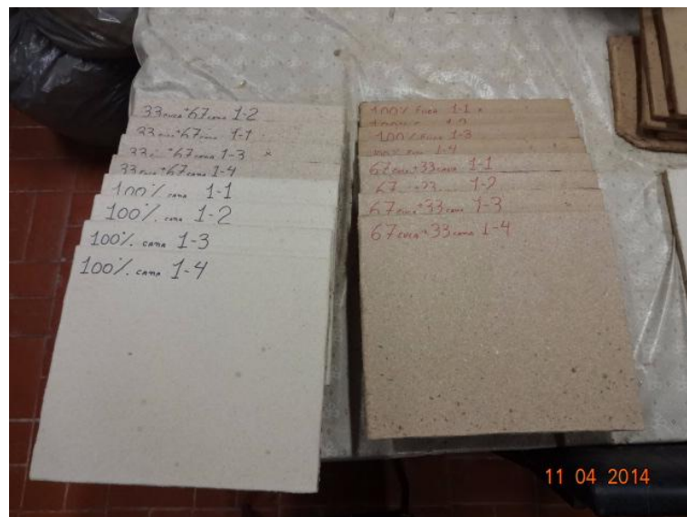
Figura 31. Painéis fabricados (Fonte, autor)
