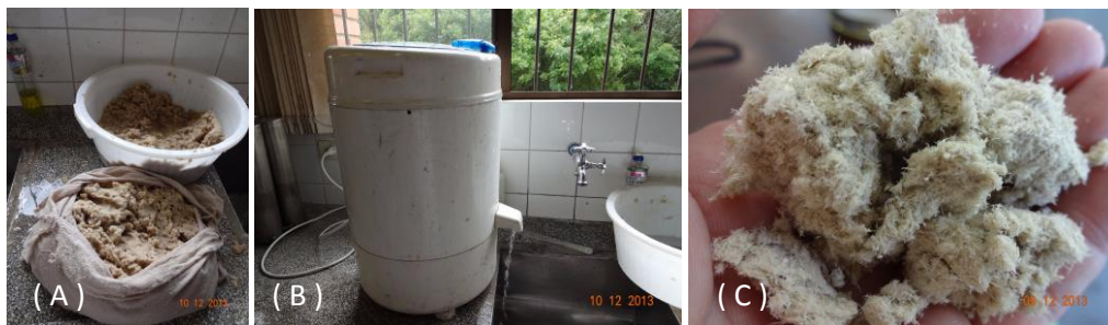
Figura 18. Massa úmida de bagaço (A), equipamento de centrifugação do bagaço (B) (Fonte, autor)
