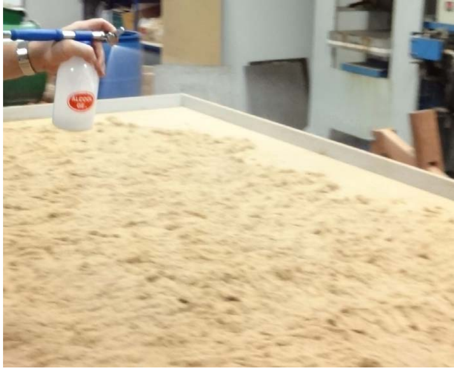
Figura 26. Processo de pulverização do adesivo em forma de névoa sobre as fibras (Fonte, autor)
