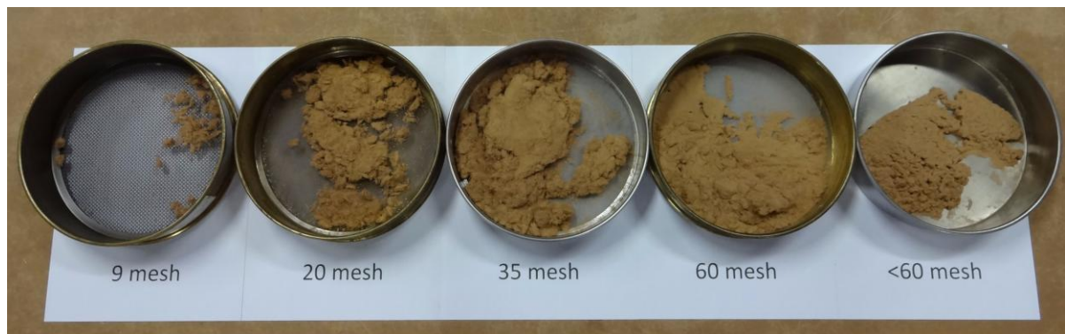
Figura 38. Distribuição granulométrica das fibras de eucalipto (Fonte, autor)
