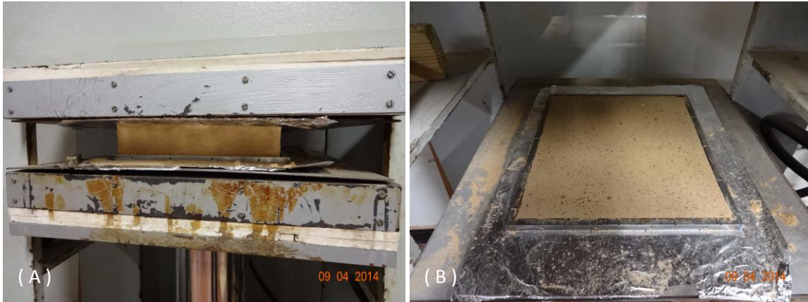
Figura 30. Colchão de fibras sendo prensado (A) e o painel pronto (B) (Fonte, autor)
