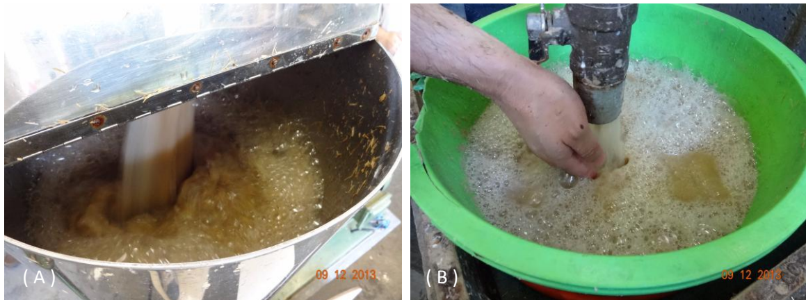
Figura 17. Fluxo do desfibrador (A) e a abertura do reservatório do desfibrador (B) (Fonte, autor)
