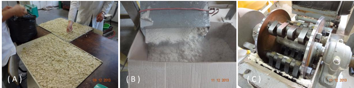
Figura 19. Massa seca de fibras de bagaço (A), Fibras marteladas (B) e o Moinho de martelo (C) (Fonte, autor)
