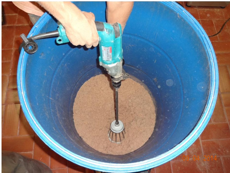
Figura 27. Tambor e sistema mecânico de mistura, composto de furadeira industrial e batedor de massa leve (Fonte, autor)
