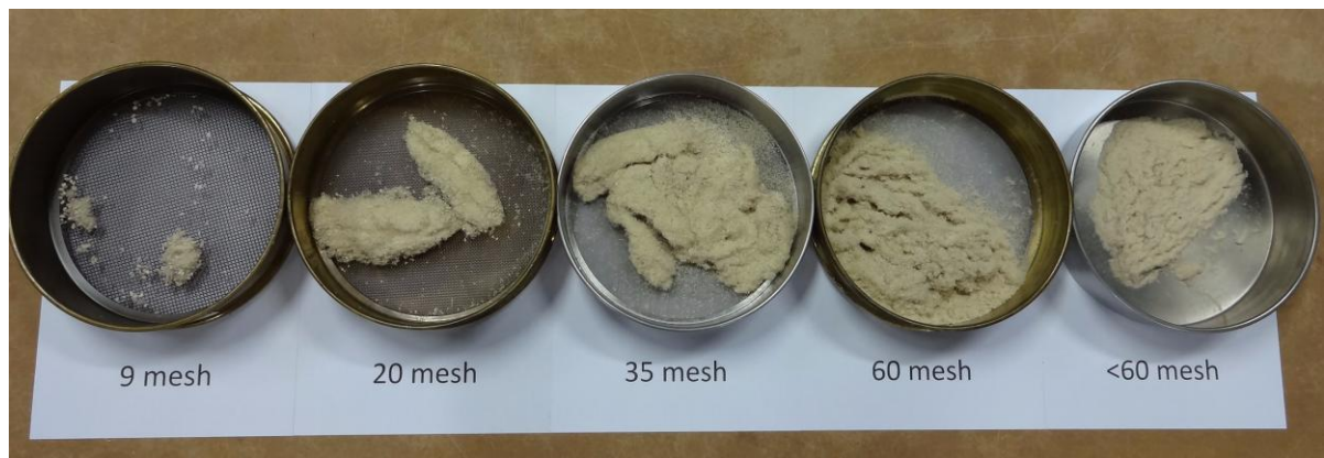
Figura 37. Distribuição granulométrica das fibras de cana-de-açúcar (Fonte, autor)
