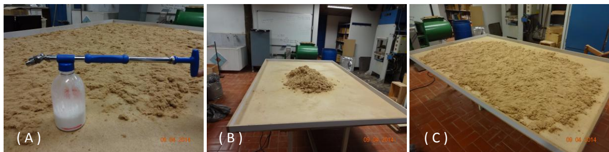
Figura 25. Adesivo no pulverizador (A), Massa de fibras (B) e massa de fibras distribuída sobre a mesa (C) (Fonte, autor)
