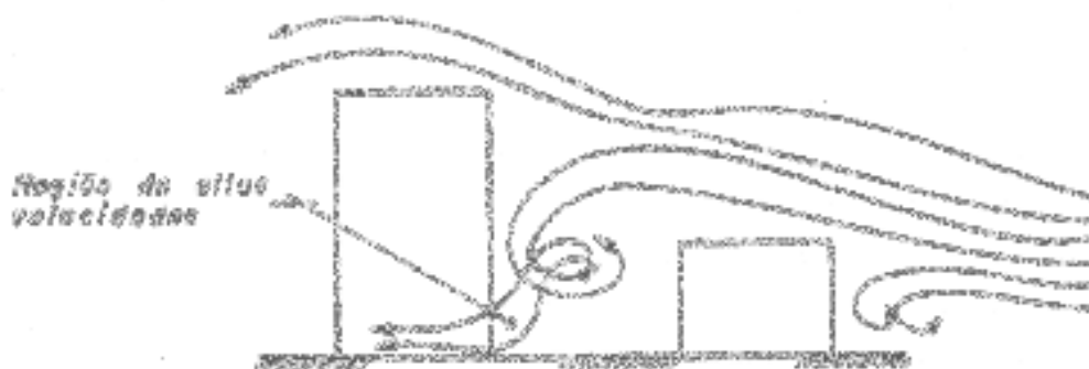
Figura 22 – Turbulência de Esteira. Fonte: Gonçalves et al (2004)
