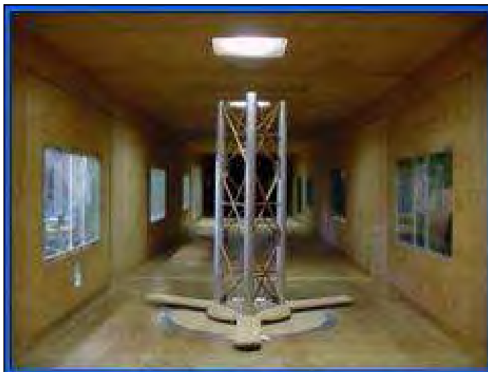
Figura 4 – Modelo Reduzido de uma Torre de Seção Triangular no Interior do Túnel do Vento. Fonte: Loredo-Souza (2003)
