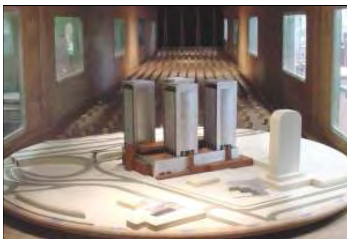
Figura 3 – Modelo Reduzido do Edifício e sua Vizinhança no Interior do Túnel de Vento. Fonte: Loredo-Souza (2004)
