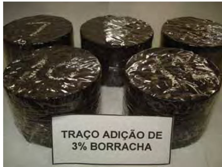
Figura 28 - Identificação dos corpos-de-prova moldados (7 a 11) do traço com adição de 3% de borracha.
