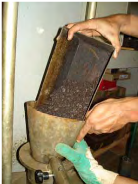
Figura 37 - Adição da mistura asfáltica no molde de compactação.
