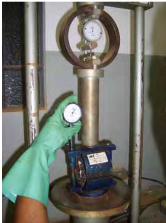
Figura 41 - Ruptura do corpo-de-prova.
