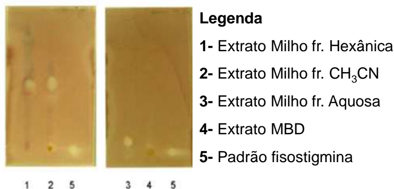
Figura 30 - Avaliação da atividade anticolinesterásica dos extratos brutos. condição cromatográfica (sílica gel – Hex:AcOEt (7:3) extratos (1 e 2) e CH 3 Cl:MeOH extratos (3 e 4)).
