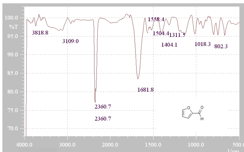
Espectro 01. Espectro no infravermelho do reagente furfural
