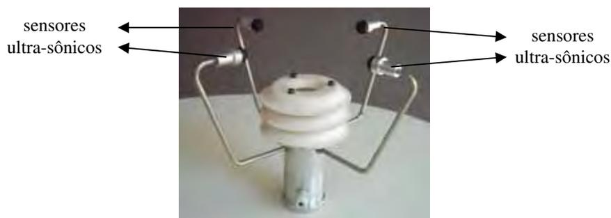
Figura 5. Posicionamento dos sensores ultra-sônicos num plano cartesiano.
