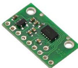
Figura 9 - Acelerômetro MMA7341L da marca Freescale.
