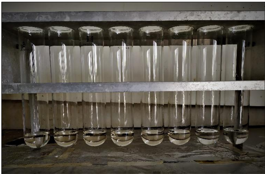
Figura 13 - Amostras de compósitos inseridas em ácido sulfúrico para digestão ácida.
