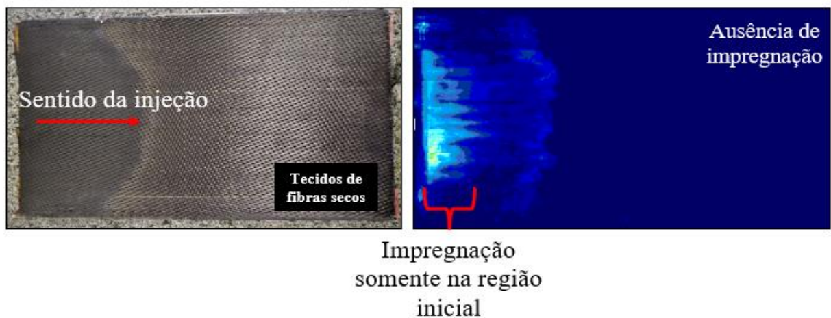
Figura 23 - Laminado 3: Processado com ausência completa de vácuo (a) e sua imagem de ultrassom (b).
