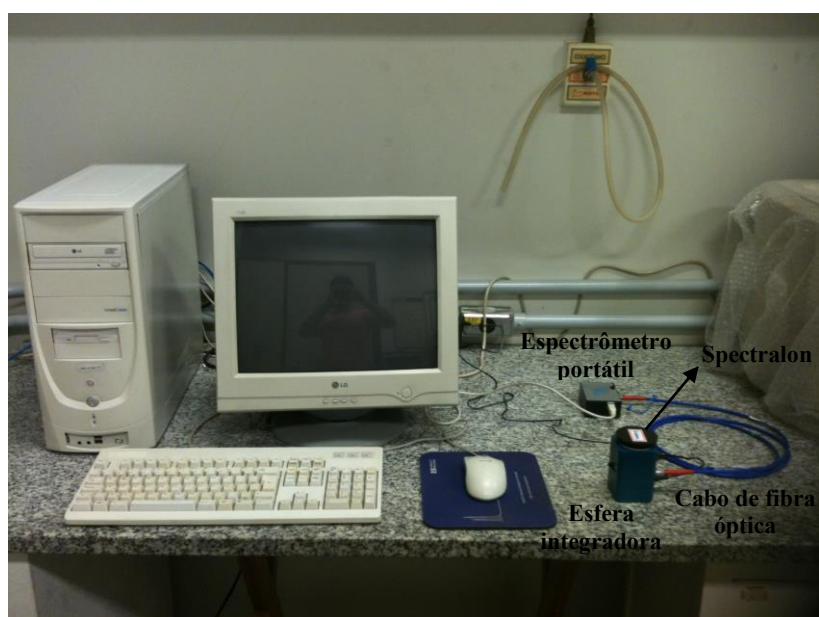
Figura 7. Sistema de medidas de reflectância difusa portátil montado.
