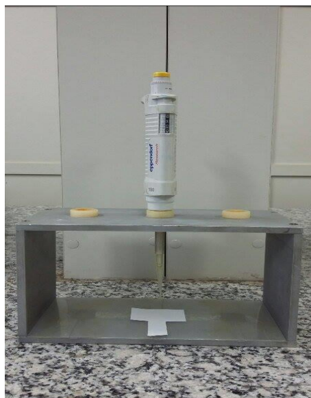
Figura 4. Suporte metálico utilizado para a confecção dos spots tests .
