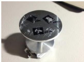
**Figura 12.** Preparação das micropartículas para Microscopia Eletrônica de Varredura de Alta Resolução.
