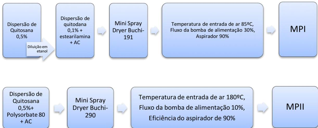
**Figura 10.** Fluxograma representativo da obtenção da MPI e MP2.
