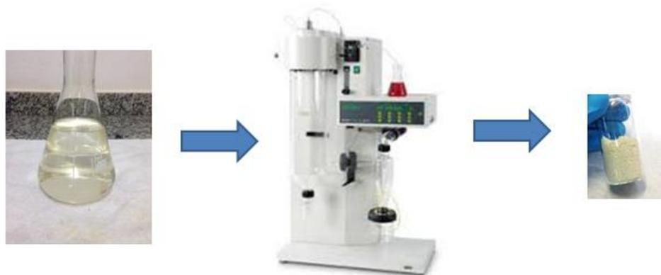
**Figura 53.** Obtenção de micropartículas por *spray drying*.
