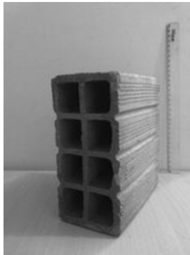
Figura 1. Bloco cerâmico utilizado nos ensaios para determinação de características físicas e geométricas.
