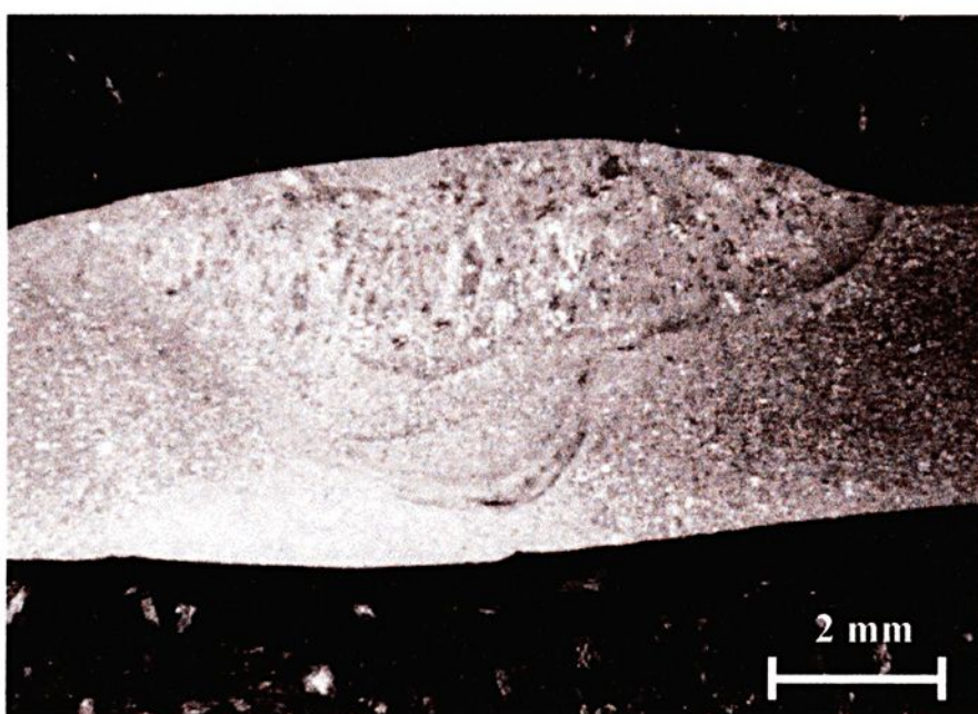
FIGURA 4.15 - Cordão de solda para condição T2, onde nota-se traços da microestrutura dendrítica de solidificação na ZF.
