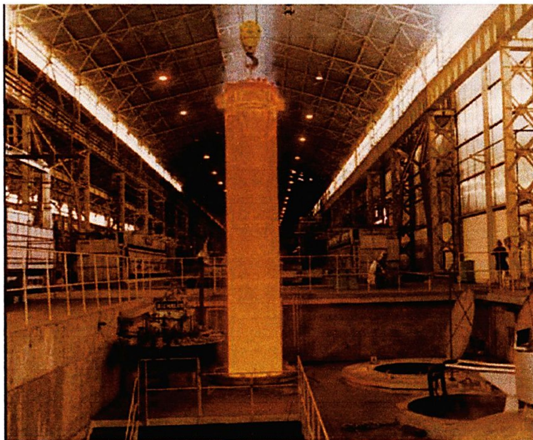
FIGURA 2.12 - Envelope Motor sendo transferido do forno de austenitização para a têmpera em banho de sal.
