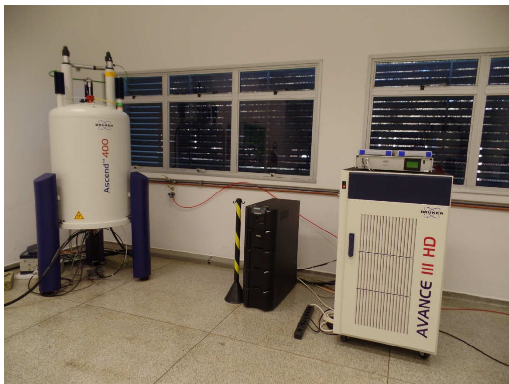
Figura 17: Foto do Espectrômetro Bruker Avance III 400 MHz utilizado na realização dos experimentos de RMN no estado sólido. No extremo à direita encontra-se o console que controla as frequências dos pulsos eletromagnéticos.
