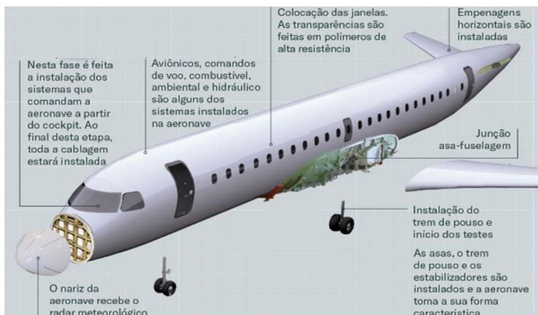
Figura 15: Montagem e instalação de peças na fuselagem de uma aeronave
