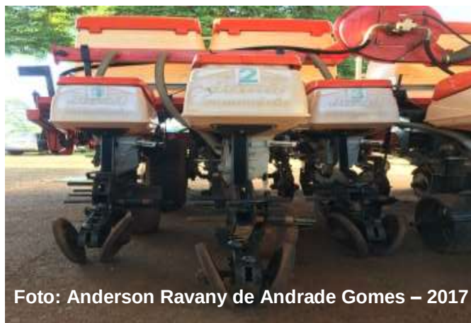
Figura 5 - Semeadora com mecanismo de distribuição de sementes pneumática.
