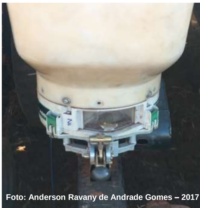
Figura 7 - Dosador de sementes Tittanium.
