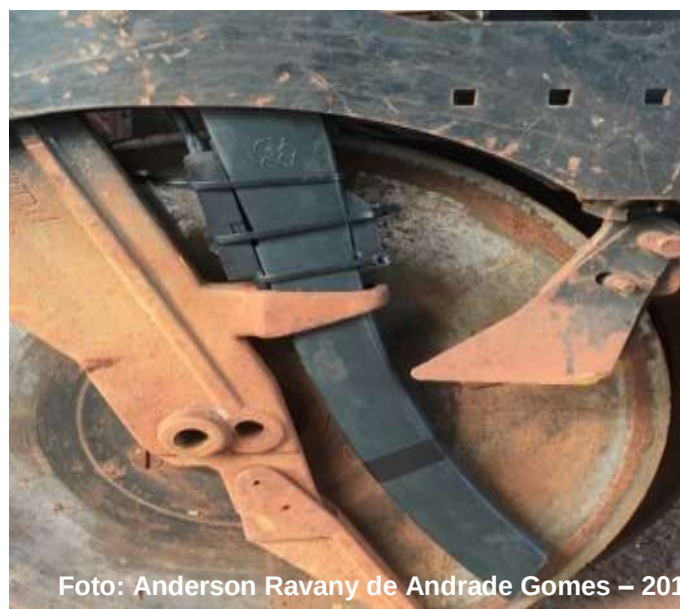
Figura 8 - Sensor com fio instalado no tubo condutor de sementes.
