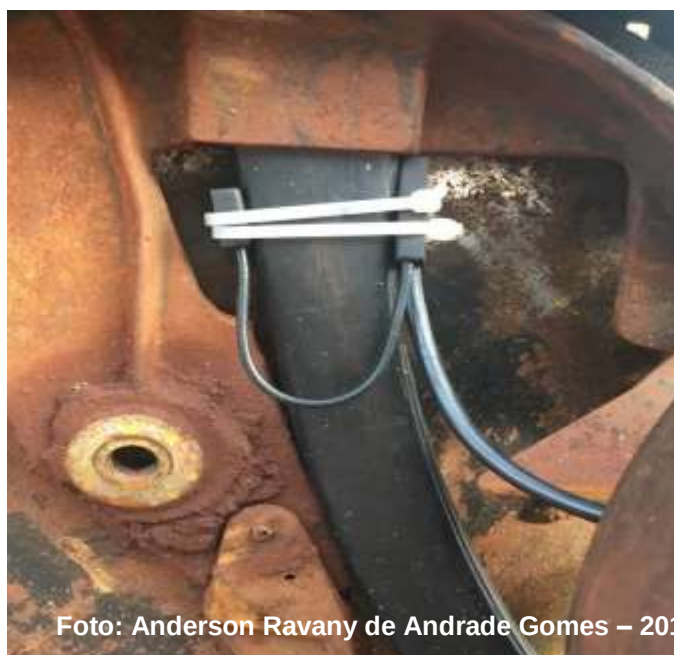
Figura 9 - Sensor sem fio instalado no tubo condutor de sementes.
