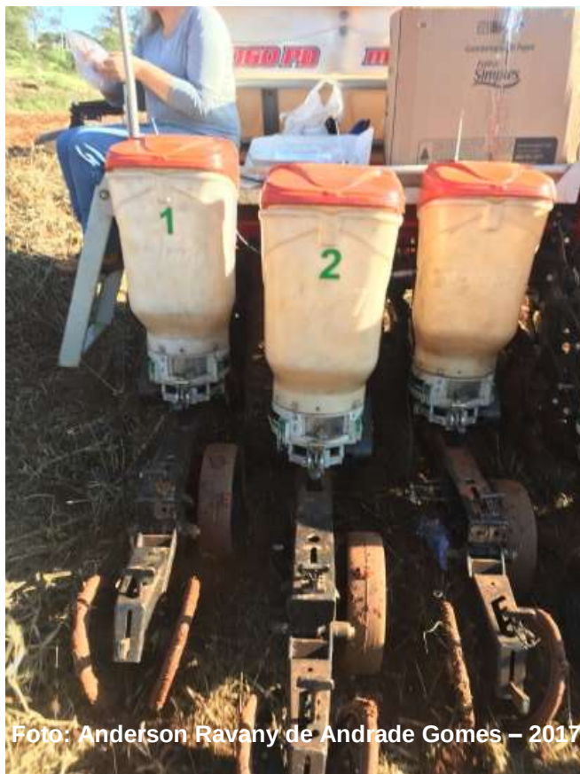
Figura 6 - Semeadora com mecanismo de distribuição de sementes de disco horizontais.
