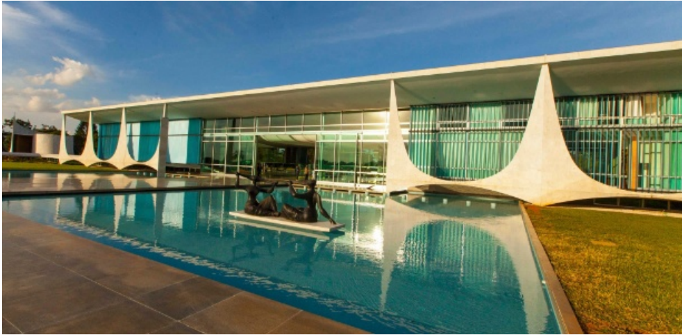
Figura 19 – Espelho d’água onde ocorre o resfriamento evaporativo no Palácio do Planalto
