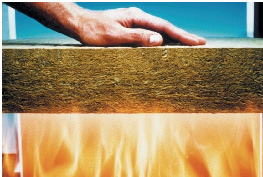
Figura 5 – Exemplo de isolamento térmico com lã de rocha
