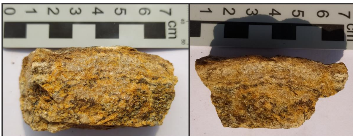
Figura 16: Forma de ocorrência da isalterita caulinítica
