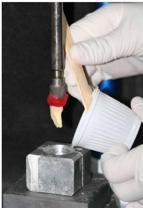
Figura 2- Preparo para inclusão: Posicionamento do dente na haste vertical de um delineador para inclusão em poliuretano.
