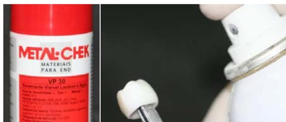
Figura 13- Aplicação do evidenciador de trincas.
