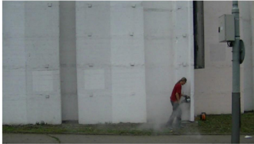
Figura 24 - Retirada de amostras da parede em via pública revestida com tinta à base de \text{TiO}_2
