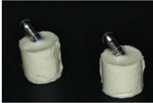
Figura 1 - Espécime formado pelo implante embutido, pilar protético, parafuso de retenção e dispositivo metálico que simula a coroa protética.
