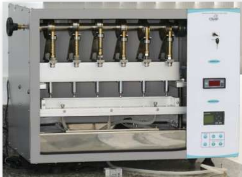
Figura 5 - Equipamento eletromecânico de ensaio de fadiga por mastigação.
