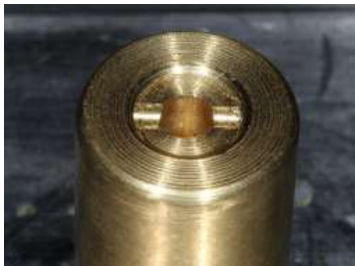
Figura 2 - Dispositivo de aço inoxidável no qual foi posicionado o parafuso de retenção
