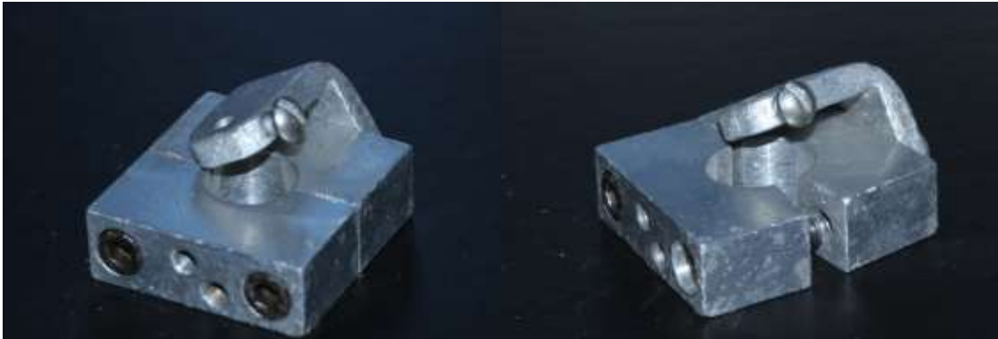
Figura 1 - Matriz metálica bipartida para o embutimento dos implantes osseointegráveis.
