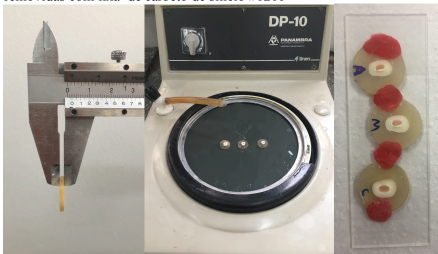
Figura A5- Espécimes seccionados transversamente ao longo eixo radicular e irregularidades das secções removidas com lixa de carbeto de silício #1200
