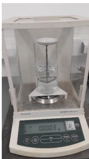
Figura 9: Balança hidrostática (Fonte: autor).
