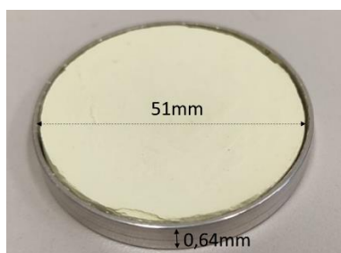
Figura 8: Alvo acoplado ao suporte para uso no equipamento de sputtering (Fonte: autor).
