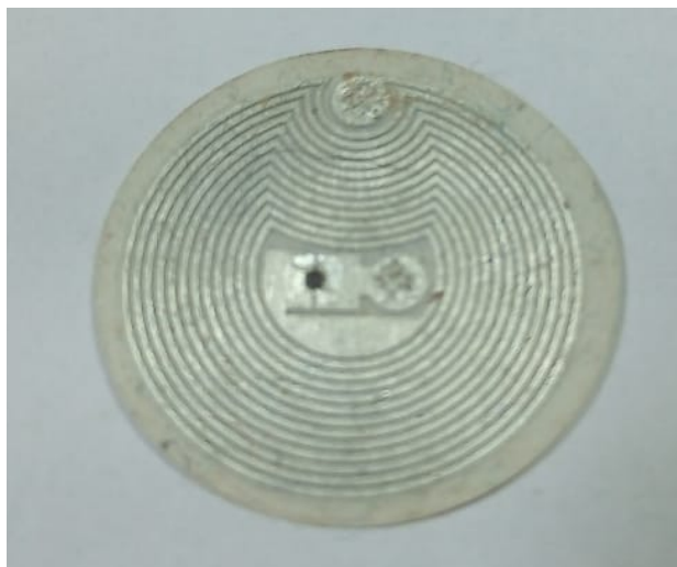
Figura 16 - Tag RFID utilizada para a extração do CI NXP NTAG 213.
