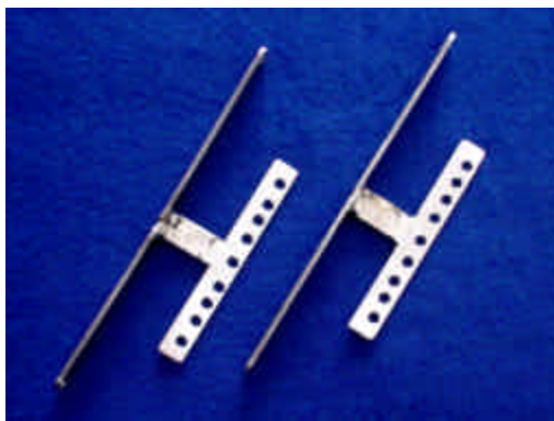
Figura 6 - Placas metálicas perfuradas para permitir agitação da solução água/dentífrico durante os ensaios.
