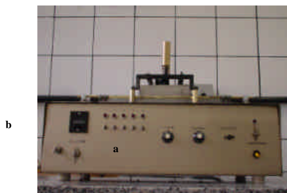
Figura 4 - Máquina de escovação (vista frontal).
