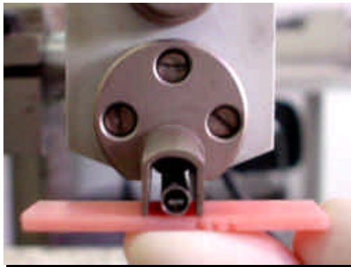
Figura 8 - Corpo-de-prova sendo posicionado de acordo com as linhas de referência preparadas nas superfícies laterais.
