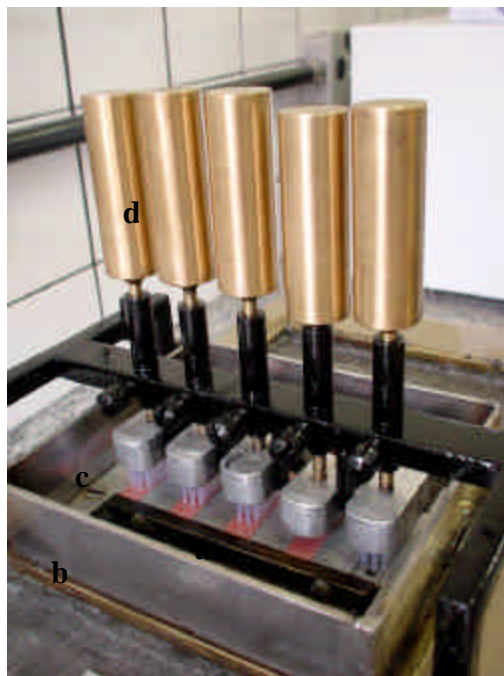
Figura 5 - Máquina de escovação (vista superior).
