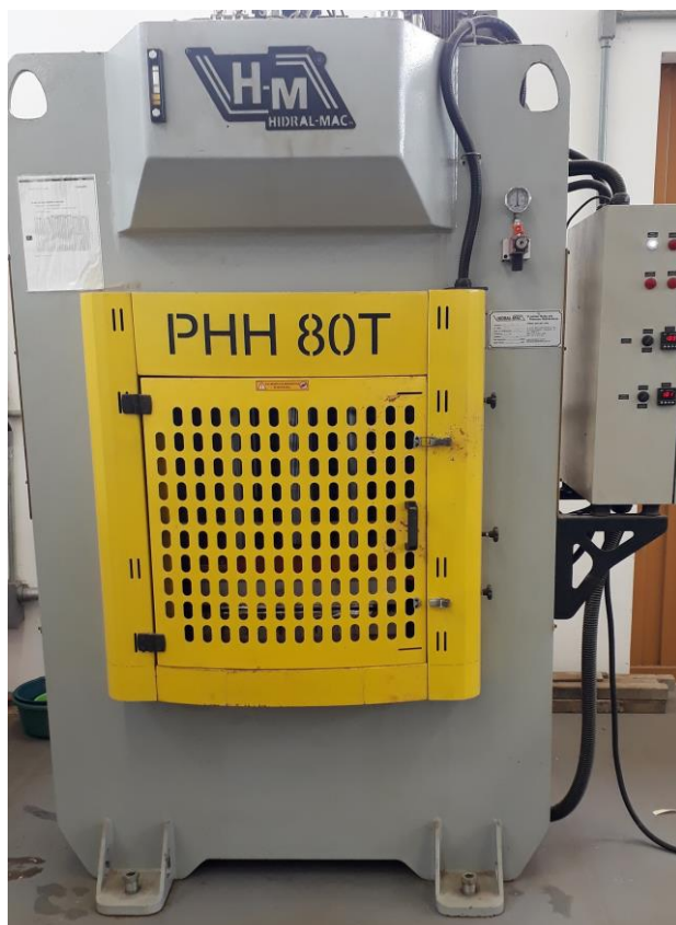
Figura 12 – Prensa hidráulica termo-mecânica
