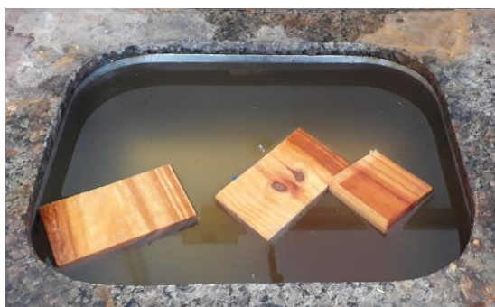
(a) Peças seccionadas sendo umidificadas
