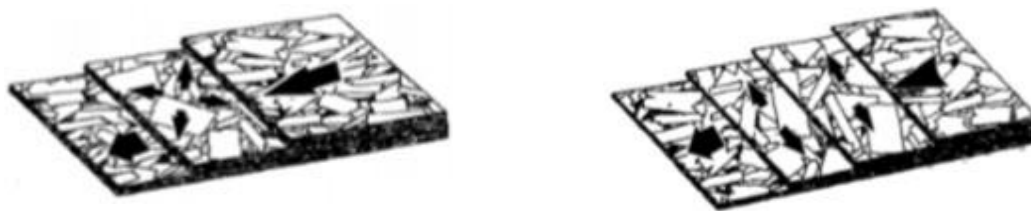
(a) Painel com partículas internas distribuídas aleatoriamente (b) Painel com partículas internas de forma orientadas
