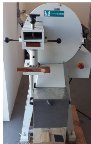
(b) Picador utilizado para geração das lascas
