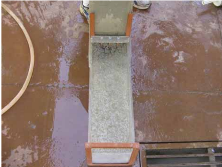
Figura 19 - Ensaio da caixa L sendo executado.
