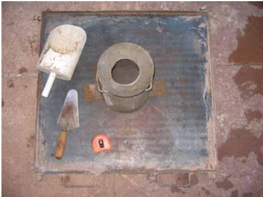
Figura 13 - Ensaio de slump flow test.
