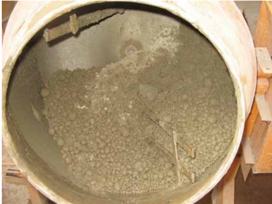
Figura 8 - Concreto antes da colocação do superplastificante.
