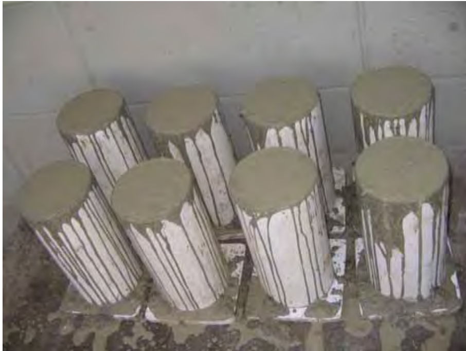
Figura 10 - Corpos-de-prova moldados, ainda em seu estado fluido.
