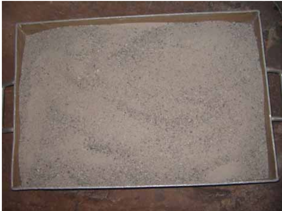
Figura 24 - Resíduo de concreto com granulometria média.
