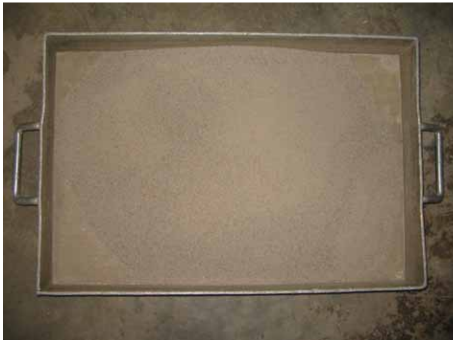
Figura 26 - Resíduo de concreto com granulometria fina.
