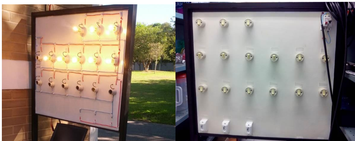
Figura 2 - Quadro de cargas resistivas.
