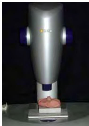
FIGURA 13- Modelo em gesso CAM-base sendo escaneado por Scanner Ineos.
