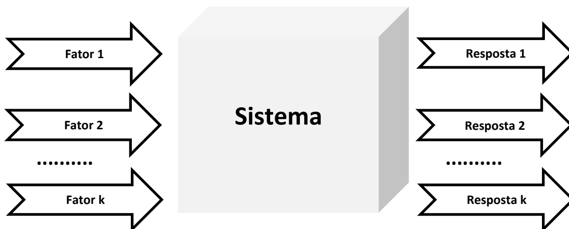
Figura 5 – Sistema representando uma função (em princípio a ser estudada), a qual é a ligação entre os fatores (variáveis de entrada) e as respostas (variáveis de saída).
