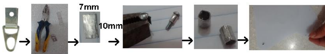
Figura 27 – Processo realizado para fazer as buchas de alumínio.
