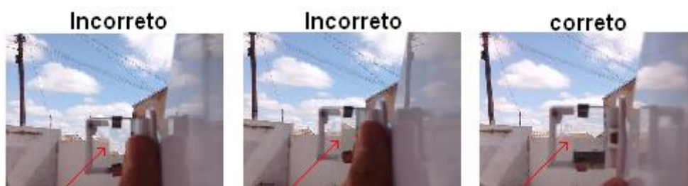
Figura 36 – Ajuste horizontal do espelho pequeno: Nas duas primeiras situações as imagens, refletida e direta, do muro estão desalinhadas; No terceiro caso, as imagens do muro se coincidem horizontalmente.
