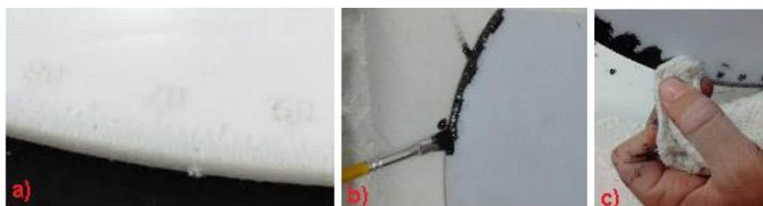
Figura 24 – Pintura do limbo: a) escala inicialmente sem pintura; b) a pintura pode ser feita com pincel, preenchendo bem a gravação com a tinta acrílica; c) em seguida o excesso da tinta é removido com pano ou papel toalha.
