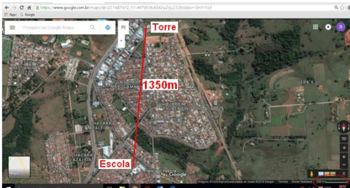
Figura 16 – O programa indica uma escala de 200m para cada 2,1cm. Medindo a distância entre os pontos escola/torre obtêm-se 14,3cm, equivalente a 1350m entre o local de observação a torre.
