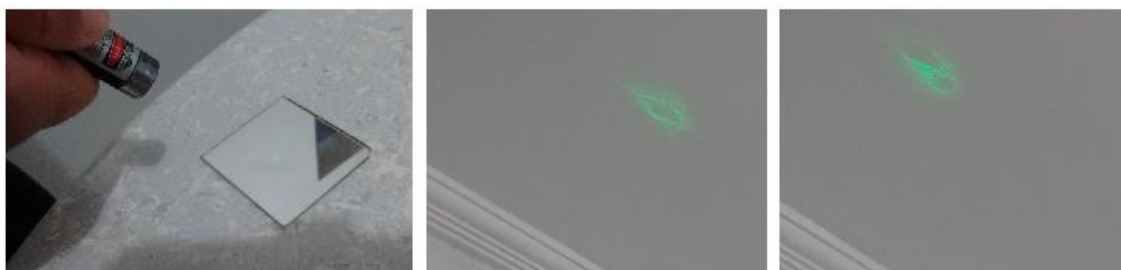
Figura 15 - A primeira imagem (à esquerda) mostra a luz sendo incidida sobre o espelho plano com uma gota de água. À direita são apresentadas as imagens projetadas pela luz refletida em um teto.
