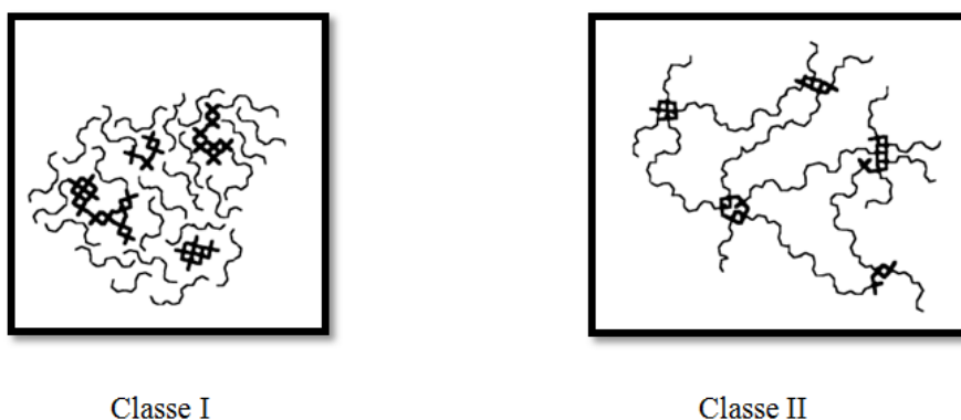
Figura 2. Representação esquemática de duas classes de HO-I. Fonte: adaptado da referência 4.
