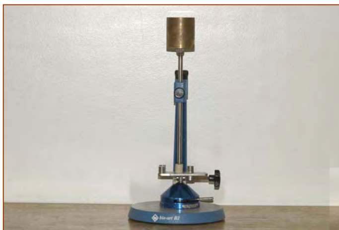
FIGURA 3a – Técnica de cimentação dos discos de cerâmica.
