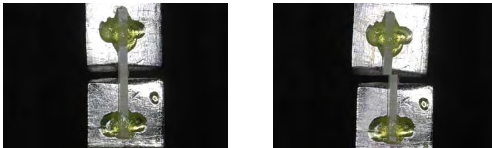
FIGURAS 4c e 4d – Aspecto dos espécimes antes e após o Teste de Micro-tração.
