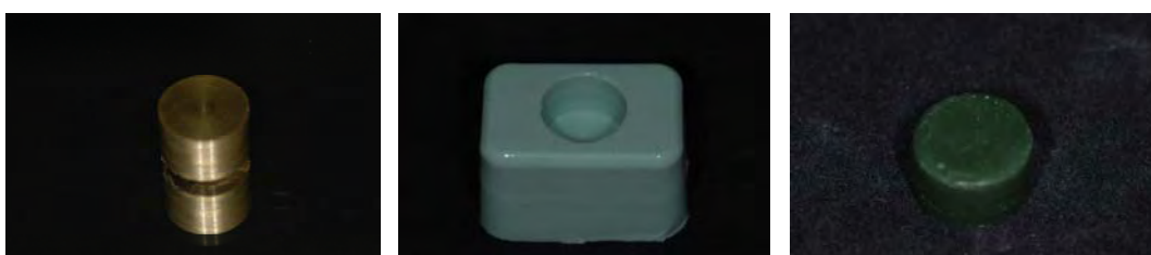
FIGURA 1a – Réplica de latão. FIGURA 1b – Matriz de silicone. FIGURA 1c – Padrão de cera.
