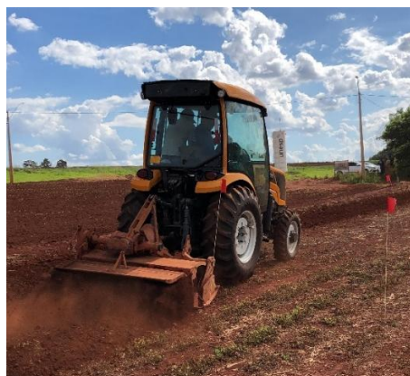
Figura 10: Preparo reduzido com enxada rotativa
