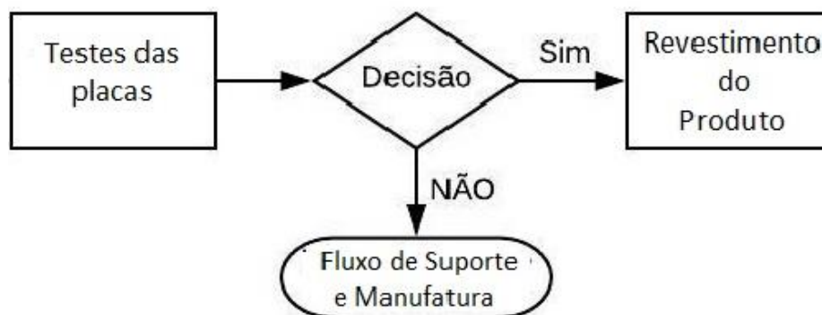
Figura 7 – Realização de testes das Placas.
