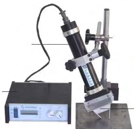
Figura 3.4- Equipamento portátil para análise de tensões RAYSTRESS
