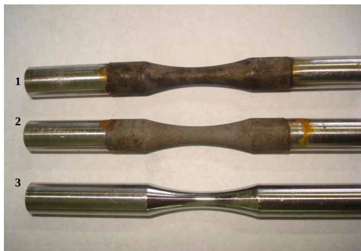
Figura 4.8- Corpos de prova após ensaio de corrosão em névoa salina: (1) WC-18Co-HVOF, (2) WC-13Co-4Cr-HVOF, (3) metal base.
