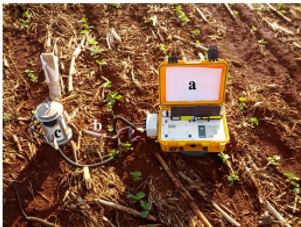
Figura 3 - (a) Sistema LI-8100 interligado à câmara de solos; (b) sensor de temperatura do solo e (c) câmara para solo inserida sobre o colar de PVC.
