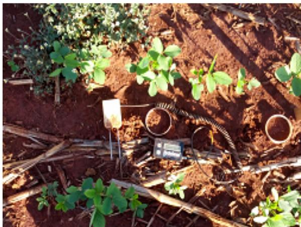
Figura 4 - TDR - “Hydrosense system”, sistema portátil utilizado para avaliação da umidade do solo.
