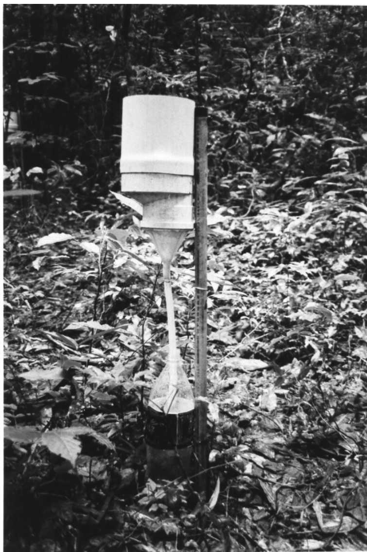
Figura 5. Modelo de interceptômetro construído.
