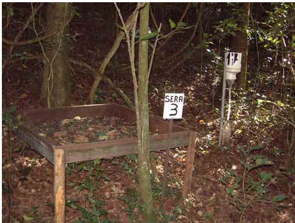
Figura 9. Sistema de coletor de serapilheira produzida.
