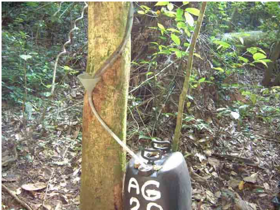
Figura 6. Sistema coletor de água escoada pelo tronco do estrato superior
