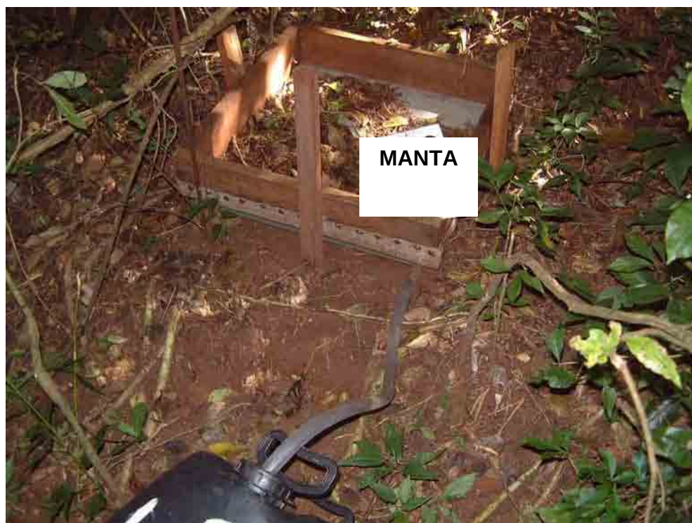
Figura 8. Sistema coletor de água que passa pela manta.
