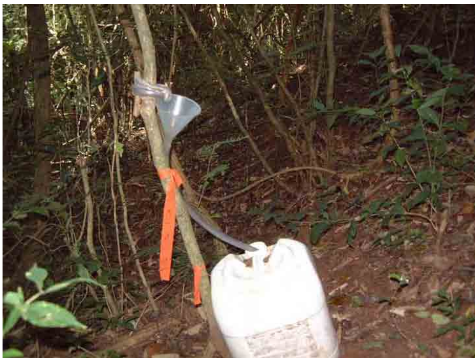
Figura 7. Sistema coletor de água escoada pelo tronco do subbosque.
