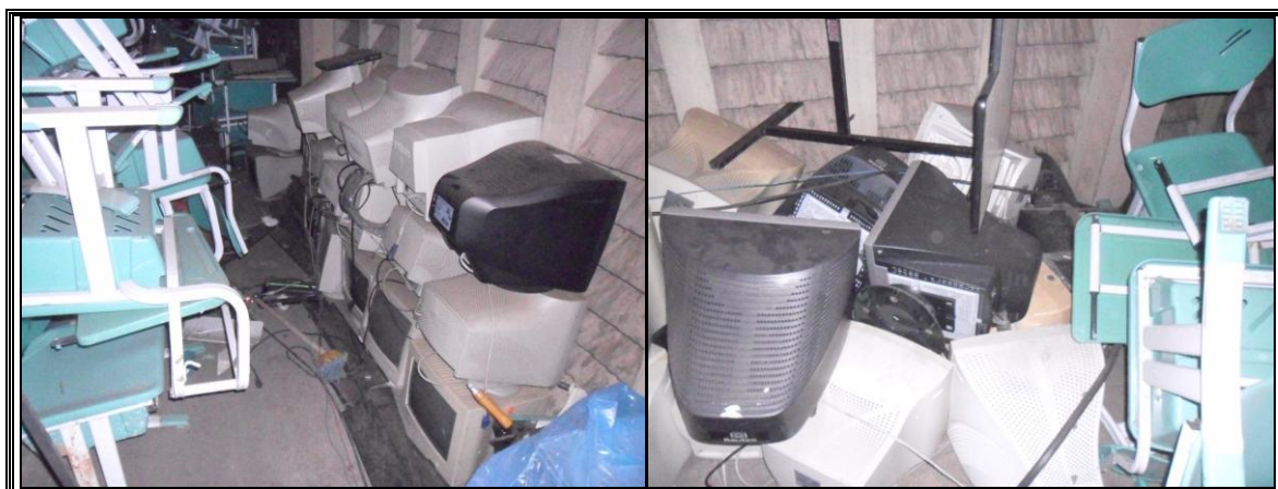
Figura 22 – Resíduos eletroeletrônicos armazenados de forma inadequada
