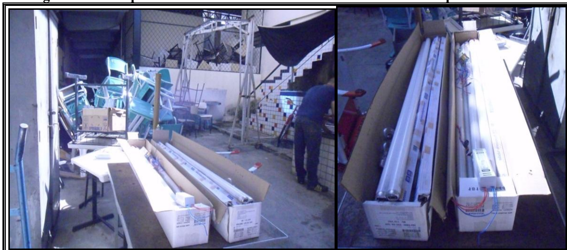
Figura 25 - Lâmpadas fluorescentes acondicionadas de modo inadequado
