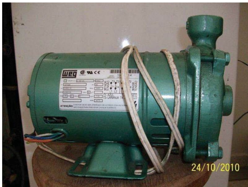
Figura 9: Bomba de recalque.
