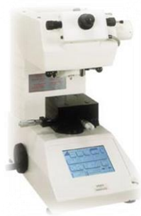
Leitura da microdureza em Durômetro Shimadzu
