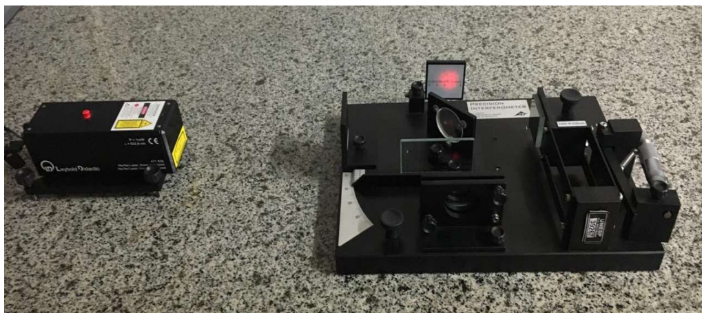
Figura 63: Interferômetro Michelson U10350
