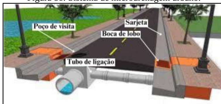
Figura 81: Sistema de microdrenagem urbano.
