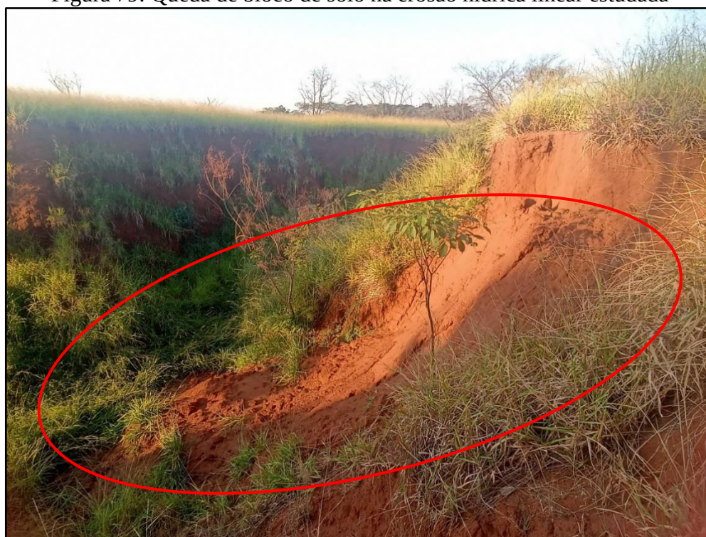
Figura 79: Queda de bloco de solo na erosão hídrica linear estudada
