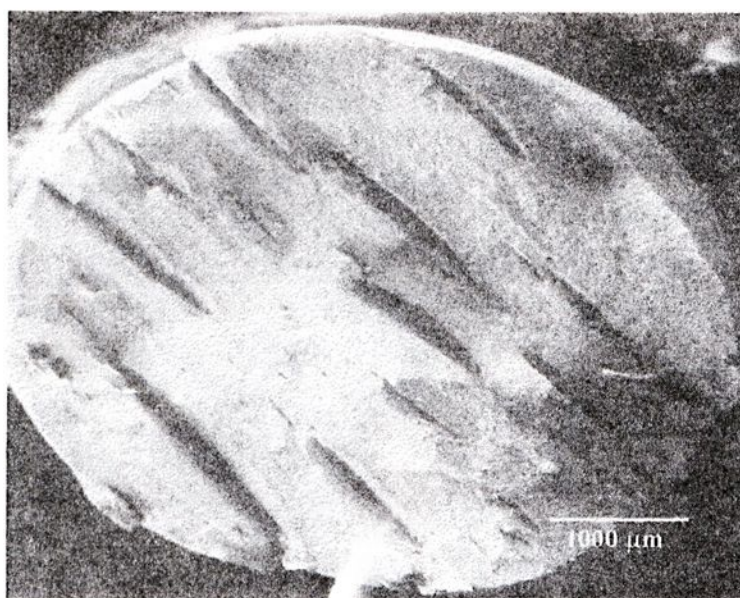
Figura 21. Amostra retirada a 45° da solda, testada 144h após a imersão no banho ácido, aspecto geral da fratura.
