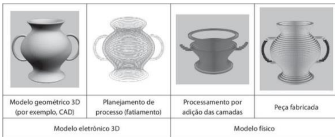
Figura 1 -Representação das principais etapas do processo de impressão 3D
