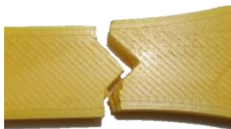
Figura 37 - Fratura para [+45^\circ/-45^\circ]
