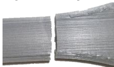
Figura 39 - Fratura para [0^\circ]
