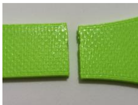
Figura 40 – Fratura para [Base XZ 0°] à esquerda, [90° a direita]
