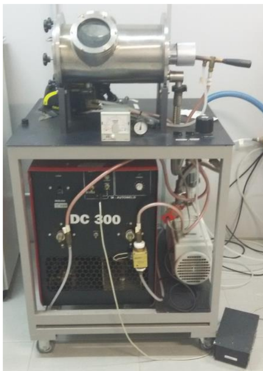
Figura 3 – Fotografia do forno de fusão a arco voltaico.
