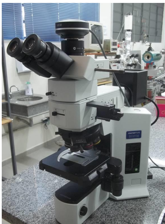
Figura 10 - Fotografia do microscópio óptico Olympus BX51M utilizado neste trabalho.
