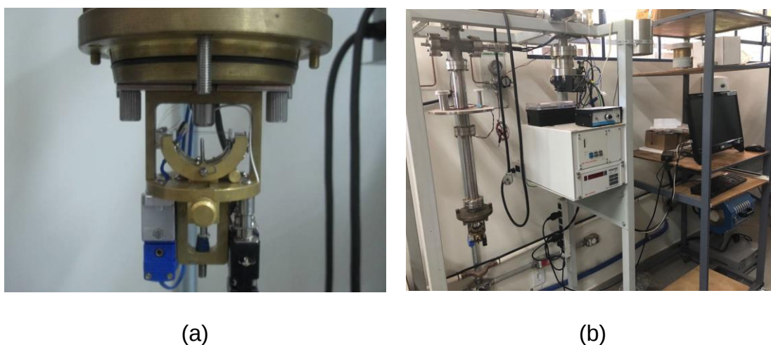
Figura 11 – Fotografia do equipamento Sonelastic® da ATCP Engenharia Física, utilizado para as medidas de módulo de elasticidade.
