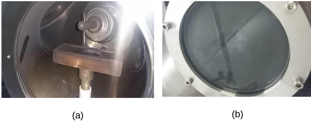
Figura 12 - Fotografias do forno sujo, aberto para a limpeza (a) e do vidro do forno, sem conseguir enxergar seu interior (b).
