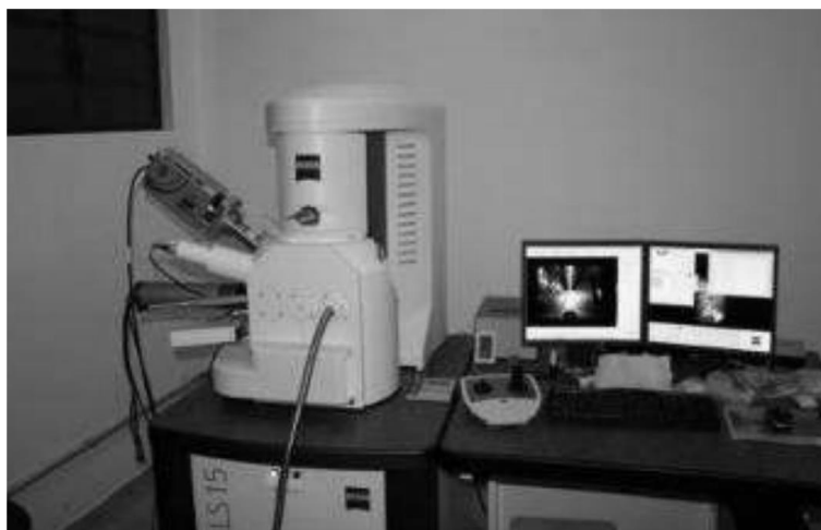
Figura 7 - Fotografia do microscópio eletrônico de varredura utilizado neste trabalho.
