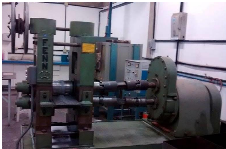
Figura 5 - Fotografia da laminadora FENN utilizada neste trabalho.
