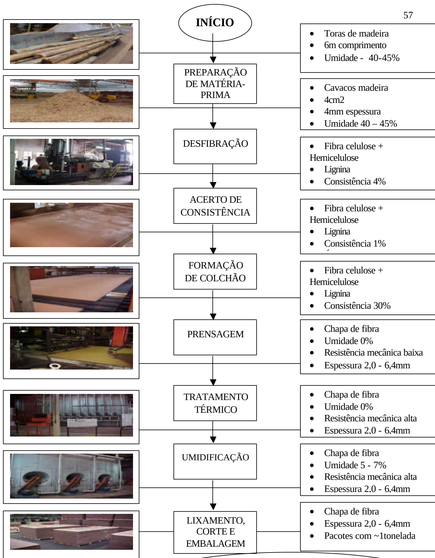
Figura 5. Fluxograma do processo de fabricação de painéis de fibra de madeira
