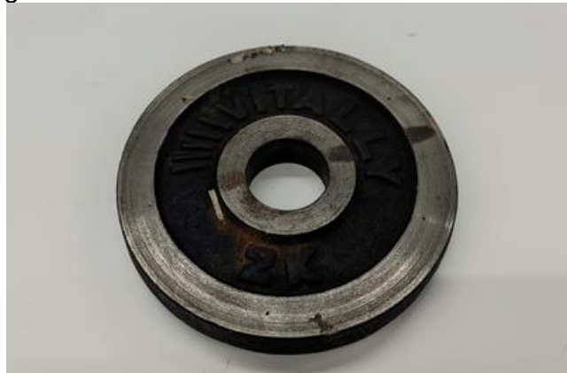
Figura 21 – Massa conhecida utilizada nos testes
