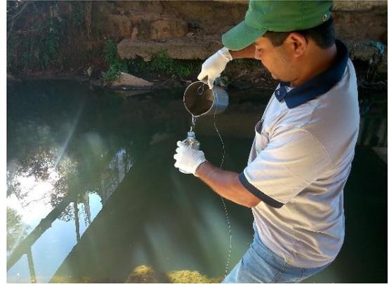
(b) Armazenamento da amostra em frasco plástico
