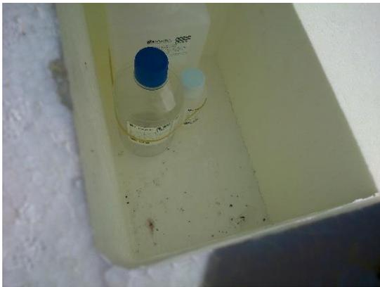
(c) Acondicionamento da amostra em isopor
